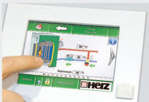
Régulation HERZ T-CONTROL avec écran tactile
